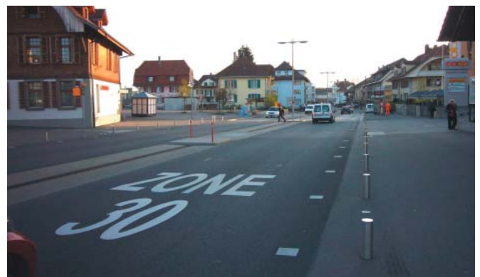
La largeur, ici de 4 m 20, permet, à 30 km/h, de dépasser en toute sécurité les cyclistes, même en l'absence de bande cyclable
