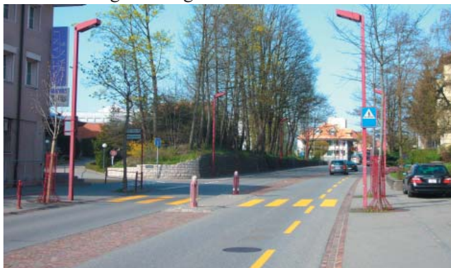
Der Abstand von einer Engstelle zur nächsten muss gross genug sein, um das Überholen von Velos durch einen LkW zu ermöglichen
