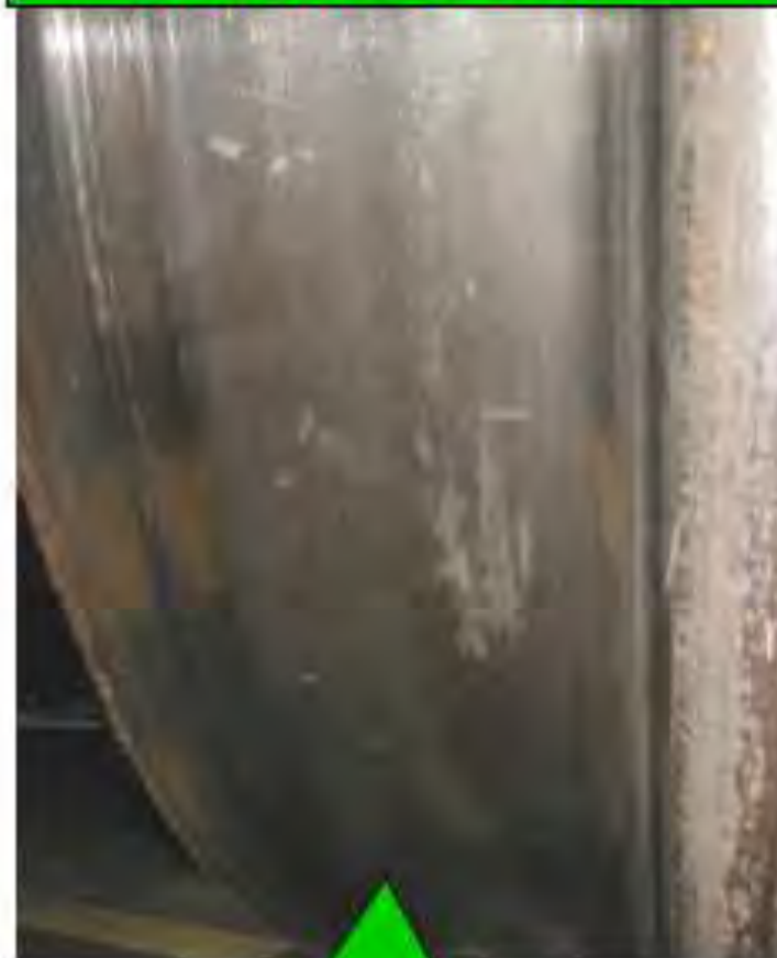
Rad mit K- Bremssohle
