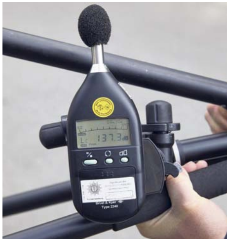
Mithilfe dieser Messgeräte kann die Landespolizei den Lärm von Autos messen. Bild: Keystone
