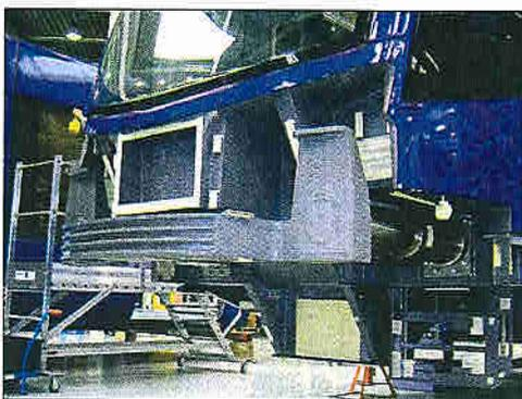
Abb. 17: Avantos Crashnase nach DIN 5560. Alle Avantos der ersten Serie von 15 Stück für die SNCF werden in Wildenrath unter 750 V DC en 25 kV, 50 Hz abgenommen. (Fotos: H. Hondius)
